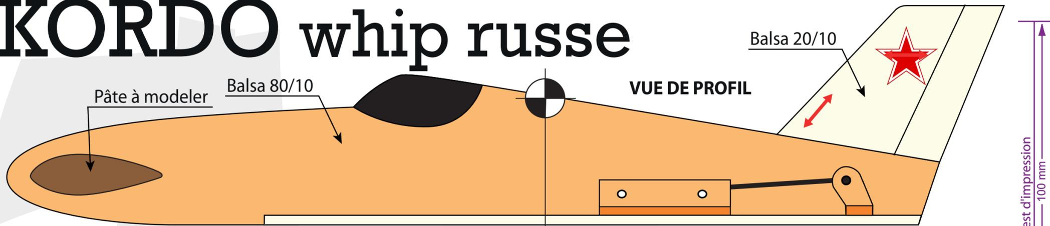
Modèle de construction simplifiée d'après un appareil des années 1960
