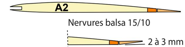
Les ailerons de courbure sont collés légèrement pour les essais à la main. Ils sont mis en place définitivement après avoir obtenu des vols corrects.
