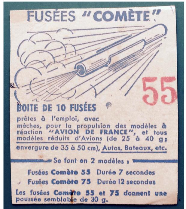
**MODE D'EMPLOI :** Bien enfoncer la mèche dans le tuyère jusqu'à son contact avec la charge fusante. Placer la fusée sur le porte-fusée du modèle en la faisant dépasser pareillement devant et derrière pour ne pas déranger le centrage général. Allumer la mèche (de préférence avec amadou ou cigarette pour allumage plus précis sans flamme). Lancer normalement dès que les gaz commencent à siffler.
