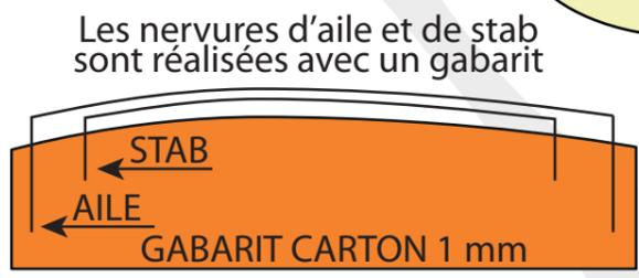
Les nervures d'aile et de stab sont réalisées avec un gabarit
