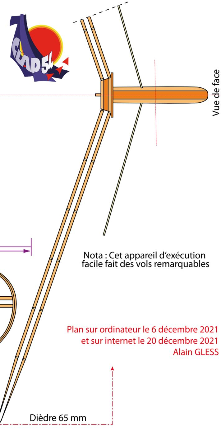
L'aile est assemblée en une seule fois - Les demi-ailes sont raccordées ensuite et maintenues par des élastiques sur le support
