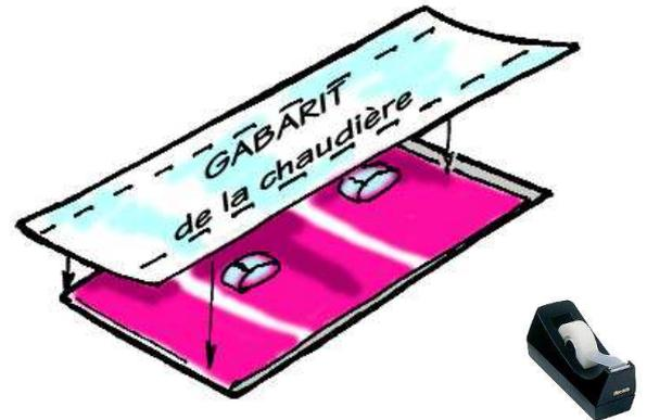
4 Collez le gabarit de la chaudière sur la feuille d'aluminium à l'aide d'anneaux de ruban adhésif (adhésif à l'extérieur). Veillez à bien aligner le bord du gabarit avec le bord retaillé de la feuille d'aluminium.
