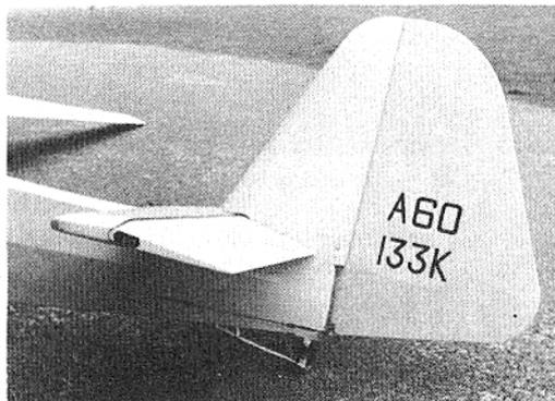
Fig. 46. — Empennage cruciforme.
