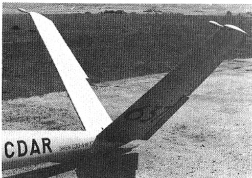
Fig. 48. — Empennage en V, dit « papillon ».
