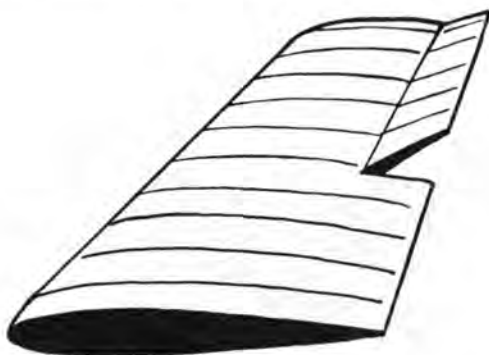
Fig 5. — Fraction d'aile montrant un aileron braqué.
