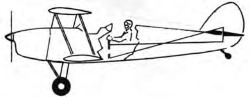
Fig. 22 bis. — Manche à balai en position neutre : l'avion conserve une position horizontale.
