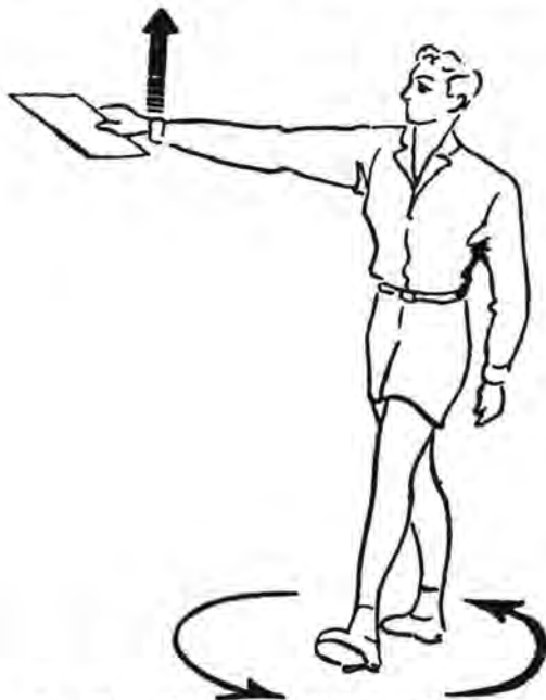
Fig. 105. — Cinquième expérience : influence de l'angle d'attaque.
