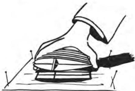
Fig. 76. — Entoilage de l'intrados d'un plan-fixe.
