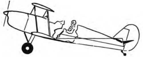
Fig. 22. — Manche à balai tiré : l'avion cabre.
