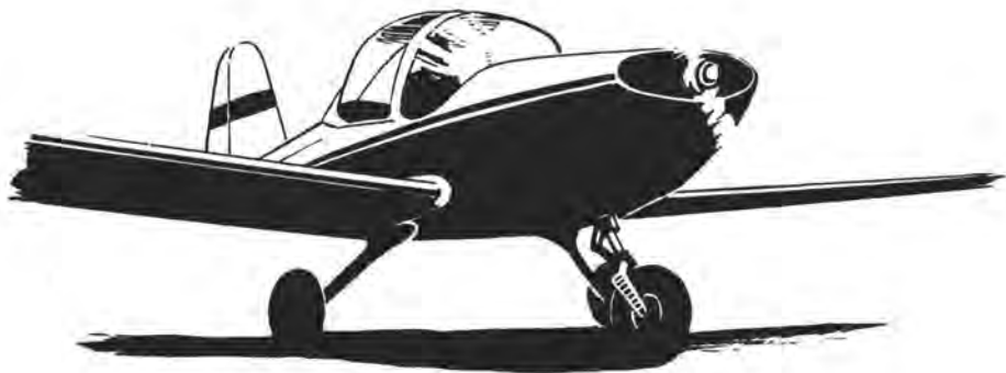
Fig. 13. — Un train d'atterrissage tricycle.
