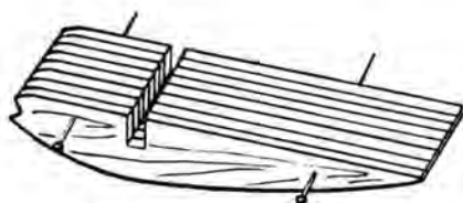
Croquis 66. — Vue en perspective d'un bloc de nervures plan-convexes enfilées sur 2 épingles.
