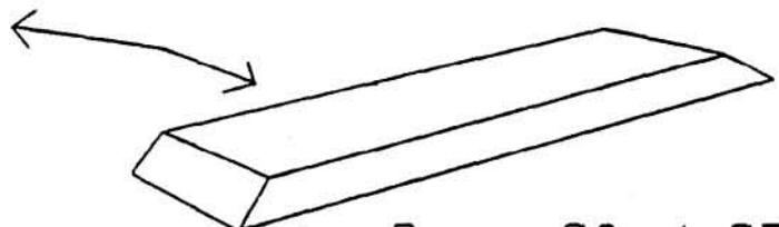
Tracer les ailerons 40x500 à 40 mm de la jonction des demi-aile, sur l'extrados.
